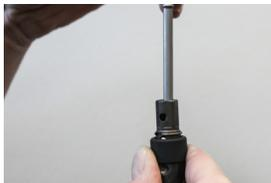
Tome una punta CAMO® DRIVE™ adicional e insértela en el extremo del collar.
