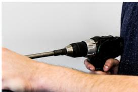
Para conectar a un portabrocas de apriete, tan solo inserte el collar grande del eje de transmisión en el portabrocas del taladro y apriete.
