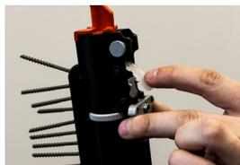
Deslice el taco hasta la punta de la herramienta y pliegue la cinta abierta sobre los dientes del taco con el dedo índice.
