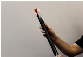
Para descargar la cinta de tornillos instalada, deslice el taco hasta la punta de la herramienta en que se colocó la cinta por primera vez. Eso liberará la tensión y la cinta deberá soltarse de los dientes del taco.
