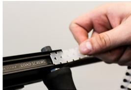
Deslice la cinta dentro del canal para cinta de tornillos.
