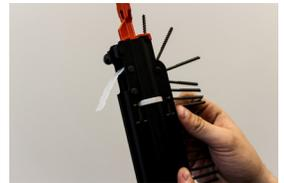
Deslice la cinta de tornillos hacia arriba y a través de la punta de la herramienta hasta que haga tope.
