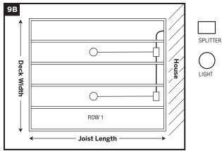
EXAMPLE OF A 2 ROW LIGHT INSTALLATION FOR JOISTS BETWEEN 9' AND 12' (2.76 - 3.65 M)
